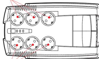
РОЗЕТКИ ПОД ЗАЩИТОЙ ИБП (БЕСПЕРЕБОЙНАЯ РАБОТА В СЛУЧАЕ ПРОПАДАНИЯ ВНЕШНЕЙ СЕТИ)
